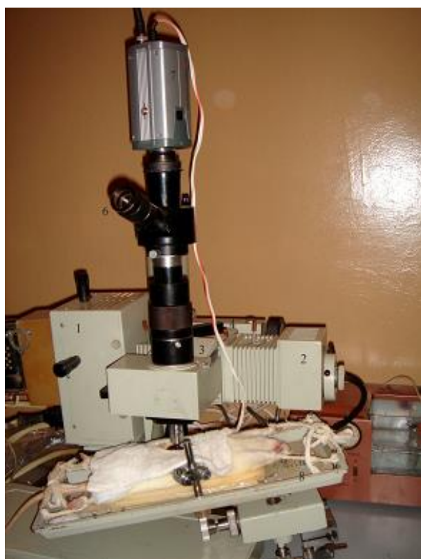
Рис. 2.6. Загальний вигляд мікроскопа «Люам К-1» з відеокамерою для дослідження мікроциркуляції in vivo з регульованою операційною платформою для фіксації тварин
